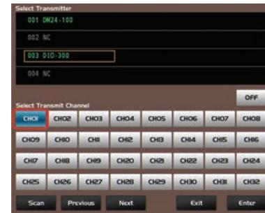
3.3). После завершения настройки можно передавать аудиосигнал. Цифровой сигнал можно назначить на шину или основной выход микшера.
