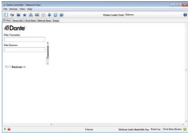
Матрица делится на две части: передача (transmitter) и прием (receiver). Устройства (два или более), подключенные к одному маршруту, отображаются как на передающей, так и на принимающей стороне, и вы можете выбрать куда отправить сигнал.
